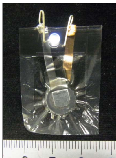
←透明樹脂ラミネートでパッケージした積層型全固体リチウムイオン電池
