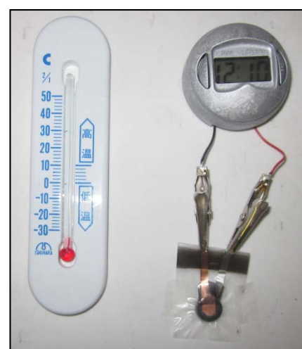
試作電池の -30^{\circ}\text{C} での駆動実証
